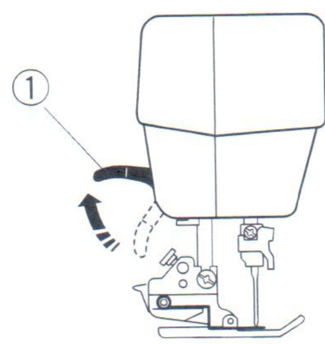
Поднимите рычаг прижимной лапки.
