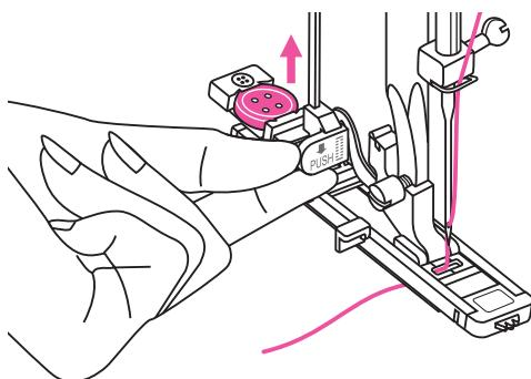
Поднять прижимную лапку и обрезать нить. Чтобы начать выполнение такой же пуговничной петли с самого начала, поднять прижимную лапку для возврата в исходное положение.
