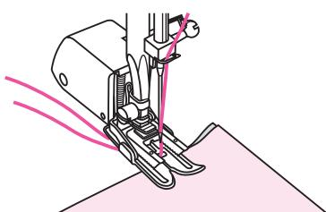
Потянуть шпульную нить вверх и поместить шпульную нить и игольную нить за креплением шагающей лапки.
