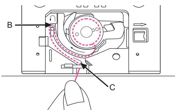
Протянуть нить в указанном стрелкой направлении по направляющей нити на пластине для строчки, из точки (B) в точку (C). Чтобы отрезать лишний остаток нити потянуть нить назад, до отрезающего лезвия в точке (C). Закрыть крышку шпулодержателя челнока.
