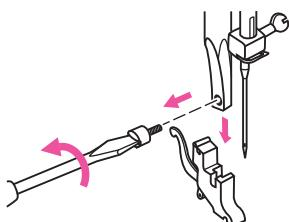
Снять держатель прижимной лапки, открутив (против часовой стрелки) винт регулировки планки нажимной лапки.
