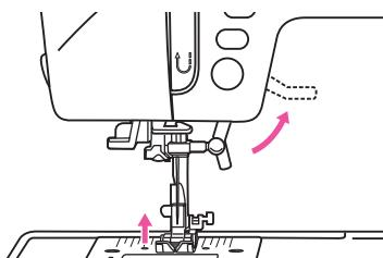
Поднять подъемник прижимной лапки, чтобы поднять планку прижимной лапки.
